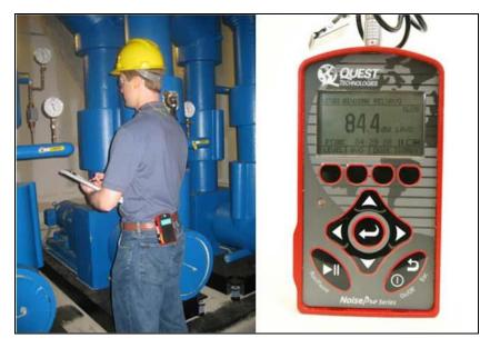
Figure 21. Noise Dosimeter
