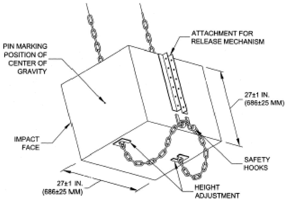
FIGURE W-21 - PENDULUM.
