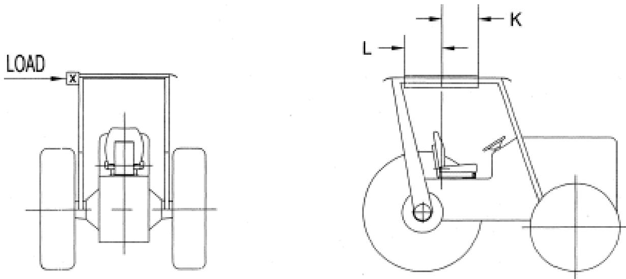
FIGURE W-25 - LOCATION OF SIDE LOAD.
