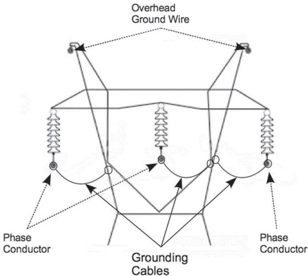
Figure 4 - Equipotential Zone for Metal Lattice Tower
