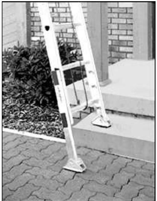
**Utilice una calza de madera o plástico o una escalera con pata de extensión cuando use escaleras en superficies desiguales.**
