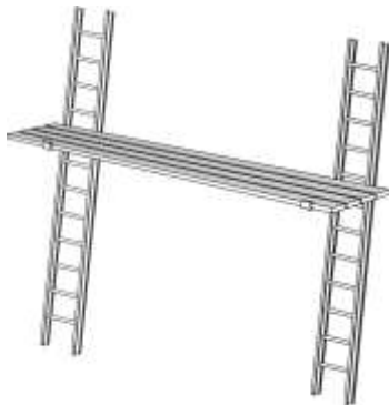
andamio de palometas en escalera
