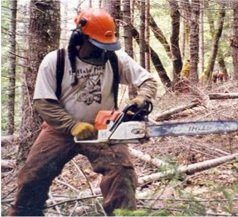
1. Evite posiciones incorrectas. Vuelva a colocar el cuerpo para mantener la estabilidad y el control del serrucho.
